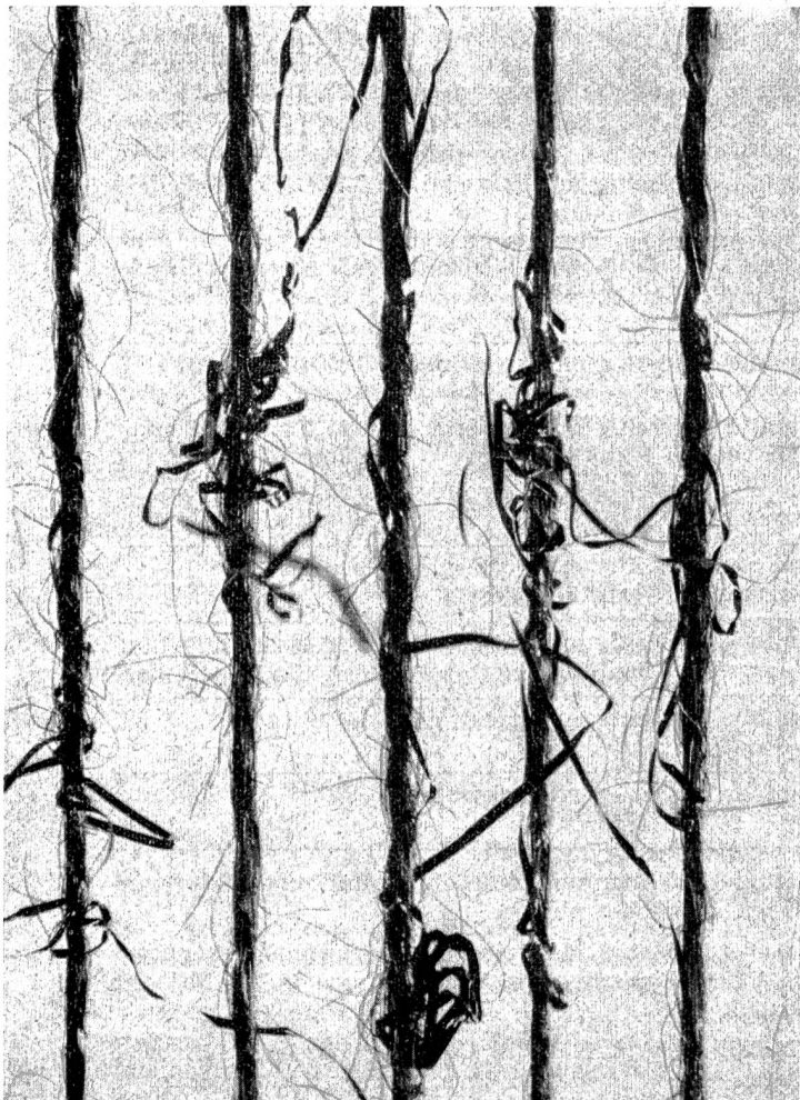
Effektgarn aus 95 % Zellwolle und 5 % eingesponnenen Metallbändchenfasern 10:1. Photo Laboratorium für Textilmikroskopie der CIBA
