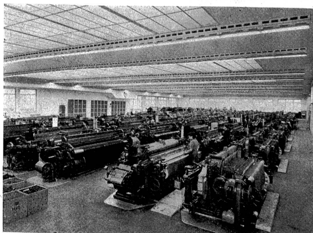
Moderner, säulenfreier Websaal einer schweizerischen Wolltuchfabrik, 100 Webstühle konventioneller Art mit einem Gesamtwert von rund 2 Millionen Franken.
