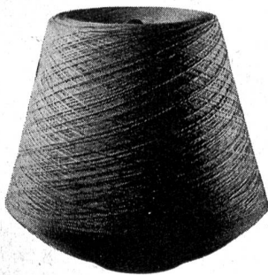
Konische Spule mit 9° 15' Konizität
