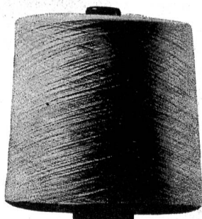
Konische Spule mit 3° 30' Konizität
