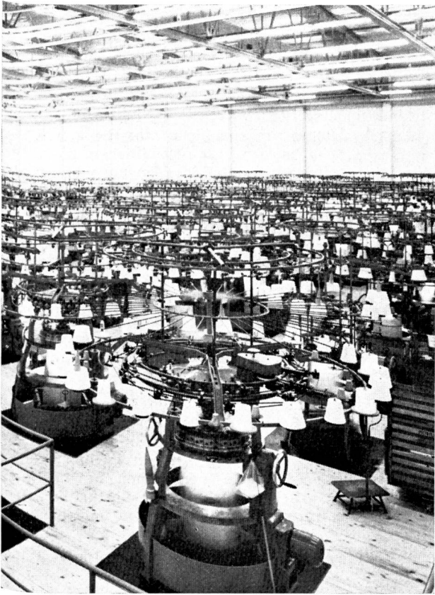
Wirkerei und Strickerei — auf mehreren hundert Rundmaschinen wird das gespulte Baumwollgarn zu Schlauchwaren in verschiedenen Breiten verarbeitet. Sechs bis acht Maschinen werden von einer Arbeitskraft bedient Werkphoto Schiesser
