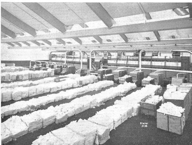
Abb. 2 Beschickung der Ballenöffner (Rieter)
