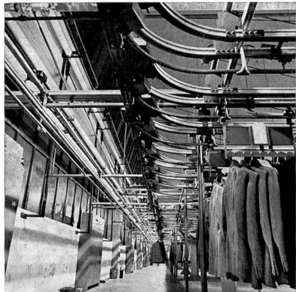
Auslagerungsseite – ein Hängewarenlager im Betrieb
