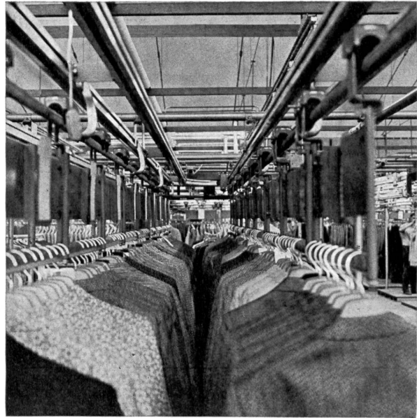
psb-HF-Lager im gefüllten Zustand, drucklos gestaute Wagen
