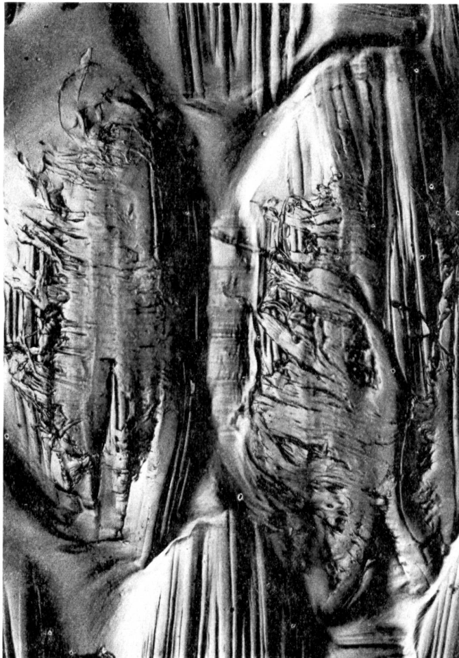
Geschädigtes Azetatgewebe (150:1); abgebildet sind 2 Bindeköpfe, die von den Kettfäden gebildet werden
