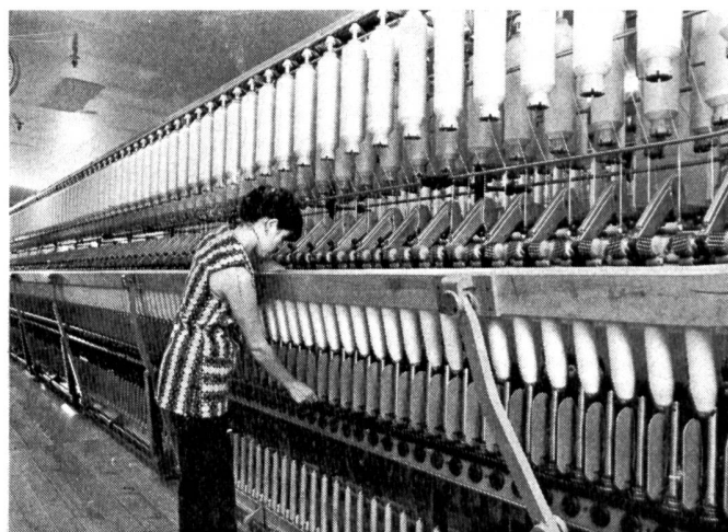
Ringspinnmaschine mit Doffer: Die neuesten Spinnmaschinen nehmen auch die vollen Kopse maschinell ab
