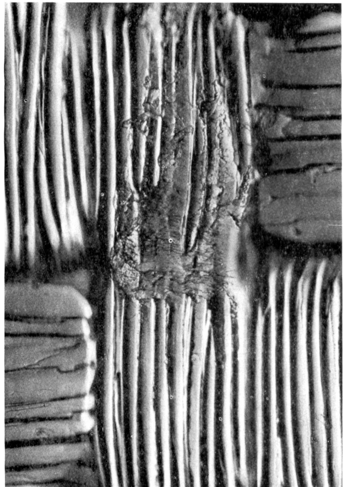
Polyamid-Futterstoff mit durch das Webschiffchen geschädigten Kettfäden (150:1)
