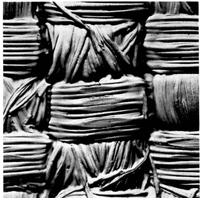
Gewebe aus Polyamid-Stapelfasern, dessen Oberfläche in Gelatine abgedrückt wurde (100:1). – Bindeköpfe aus dem Streifen, der durch die Markierung des Meterzählwerkes entstand. Auch hier ist die Schädigung durch die Deformation der Fasern zu erkennen.
