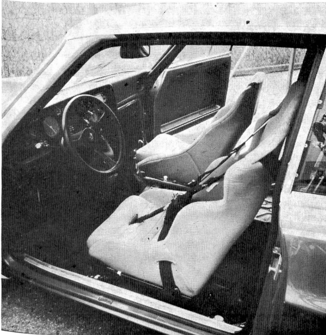
Der Sitz weist eine tiefe Schalenform mit integrierter Kopfstütze auf
