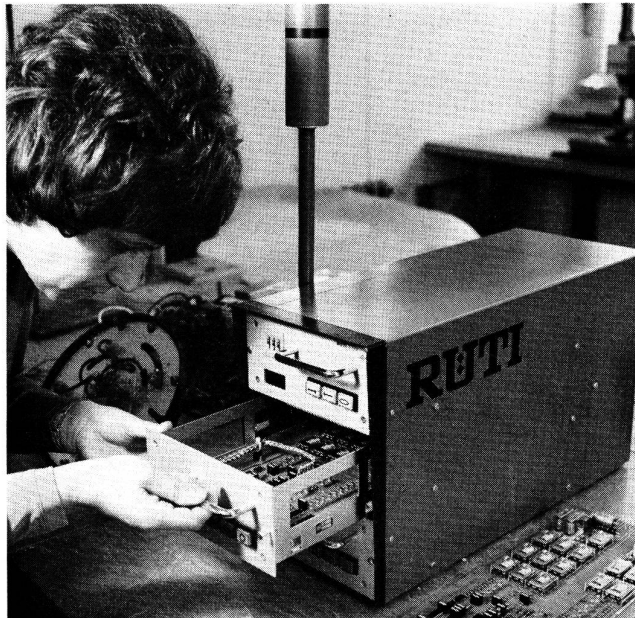
Steuerkasten mit herausgezogenem Steuereinschub
