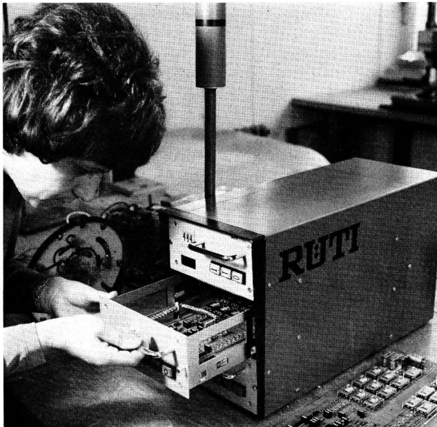
Steuerkasten mit herausgezogenem Steuereinschub
