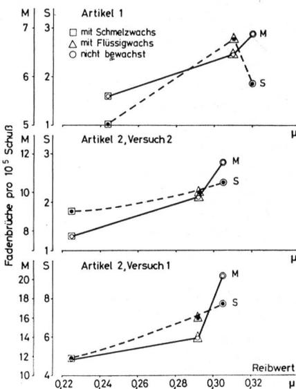
Abbildung 22 Die Abhängigkeit der Kettfadenbrüche pro 10<sup>5</sup> Schuß vom Reibungskoeffizienten  $\mu$  der Kettgarne. Die Ketten wurden mit Schmelzwachs bzw. mit Flüssigwachs nachbewachst. Die Vergleichsketten wurden nicht bewachst. M: Zahl der Fadenbrüche aus Multimomentaufnahmen; S: Zahl der Fadenbrüche aus der Zählung signierter Fäden; Artikel: 1: 5850 Fäden PES/Bw 67/33, 34/34 F/cm, Garnnummer: Nm 34/28; Artikel 2: 5846 Fäden PES/Bw 50/50, 39/23 F/cm; Garnnummer: Nm 64/64.
