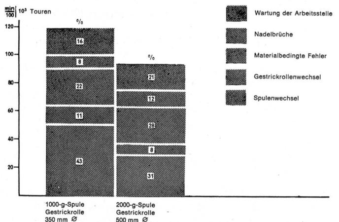
Abbildung 5 Manueller Bedienungsaufwand pro System
