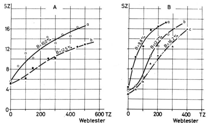
Abbildung 18 Die Abhängigkeit der «Shirley-Ziffer» SZ eines texturierten PES-Filamentgarnes dtex 50 f 18 von der Scheuertourenzahl TZ am Webtester; A: Beim Schlichten mit einem Mischpolymerisat aus Acrylestern (Charakterisierung durch den Hersteller); B: Beim Schlichten mit einer wässrigen Lösung eines Acrylatpolymerisats (Charakterisierung durch den Hersteller).
