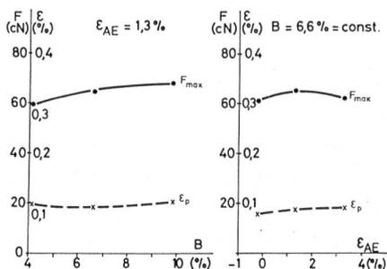
Abbildung 17 Die Abhängigkeit der maximalen Fadenzugkraft  $F_{max}$  und des plastischen Dehnungsverlustes  $\epsilon_p$  vom Beschlichtungsgrad  $B$  und vom Nassdehnungsverlust  $\epsilon_{AE}$  für PES/Bw-Mischgarn 65/35 16,7 tex (Nm 60).
