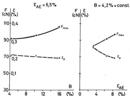
Abbildung 16 Die Abhängigkeit der maximalen Fadenzugkraft  $F_{max}$  und des plastischen Dehnungsverlustes  $\epsilon_p$  vom Beschlichtungsgrad  $B$  und vom Nassdehnungsverlust  $\epsilon_{AE}$  für Zellwollgarn 29 tex (Nm 34).
