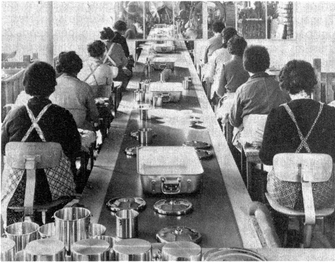
Abbildung 1 Horizontales Transportband auf Gleitunterlage. Zubringen von Metallteilen (Kochgeschirr) in einen Verpackungsraum (Bild Habasit AG).
