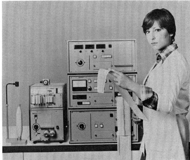
Die neue Gleichmässigkeitsprüfanlage Uster Tester I, Modell B, für Bänder, Vorgarne und Garne aus Stapelfasern.
