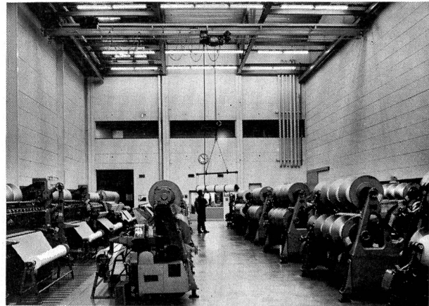
Abbildung 4 Einträger-Hängekran zum Kalanderttransport
