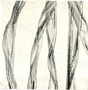
Abb. 3, 4 Baumwollfasern in der Längsansicht (Abb. 3, 400:1) und im Querschnitt (Abb. 4, 400:1).
