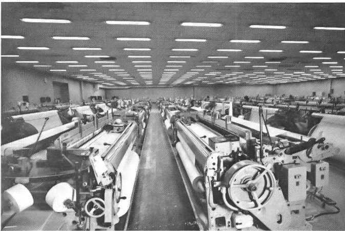
Abbildung 8 Der nach dem Condifil-Prinzip klimatisierte Websaal T5 mit 96 Sulzer-Einfarbenwebmaschinen mit Exzentermaschine in Nennbreiten von 130'' (330 cm) und 153'' (389 cm). Die Abluft wird über die Oeffnungen in der Websaaldecke abgesaugt.
