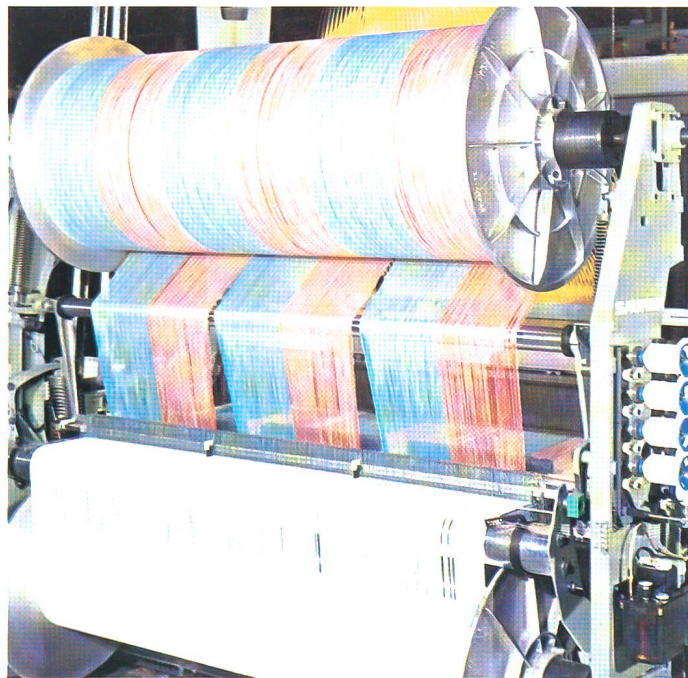
Das Kettablass-System der «terry-matic»-Frottierwebmaschine.
