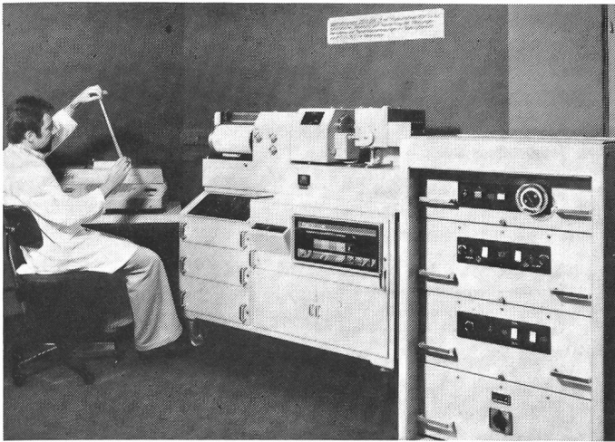
Abbildung 4 Apparatur zur Farbmessung mit angebaubtem Rechner. Die farbige Probe wird spektral abgetastet und darauf werden die farbmessrelevanten Daten errechnet und ausgedruckt.
