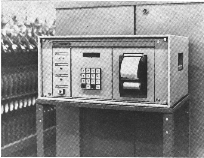
Zentraleinheit an der Ringspinnmaschine
