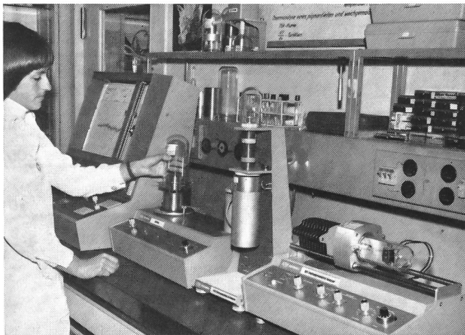
Abbildung 5 Differentialthermoanalyse, insbesondere auch zur Erfassung von Wärmetönungen. Die Apparaturen von links nach rechts: Registriergerät, Mikrokolorimeter für Wärmetönungen, Thermomechanical Analyzer zur Feststellung von Volumen oder Längenänderungen in Abhängigkeit von der Temperatur und Thermogravimetric Analyzer.
