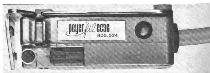
Abbildung 8 EC-36 Tastkopf und Schneideinrichtung mit Drehamboss
