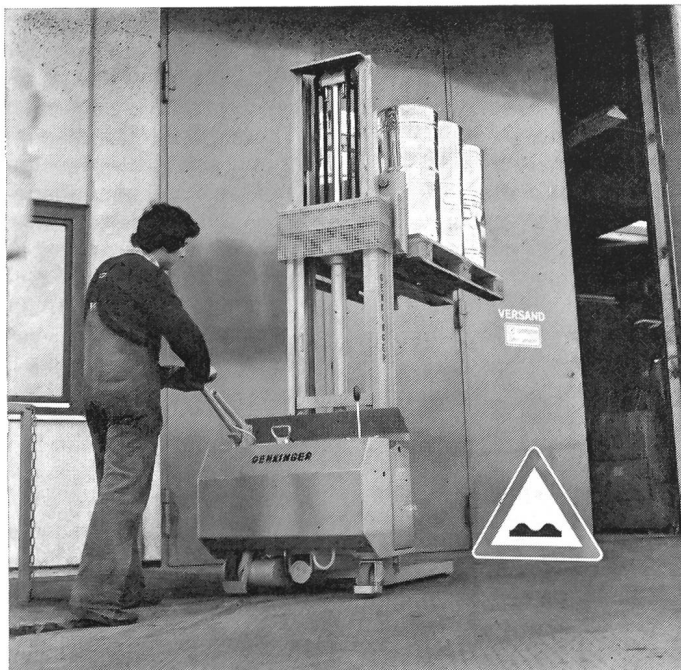
Wellenreiter EGV, ein neuer Deichselstapler mit Pendelantrieb zur Verbesserung der Bodenhaftung und zur Gewährleistung der ständigen Fahrbereitschaft beim Überfahren von Bodenwellen und -schwelen.
