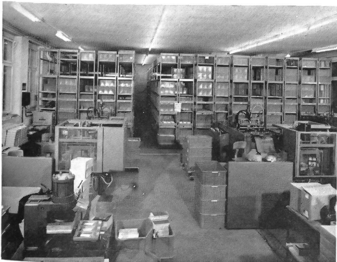
Gleitregalanlage bei CERN in Genf (Totalvolumen: die Ladung von 100 Lastzügen). Sie dient vorwiegend zur Lagerung der Versuchsapparaturen des Europäischen Nuklearforschungszentrums. — Werkfoto Foco Forster AG, Aesch.
