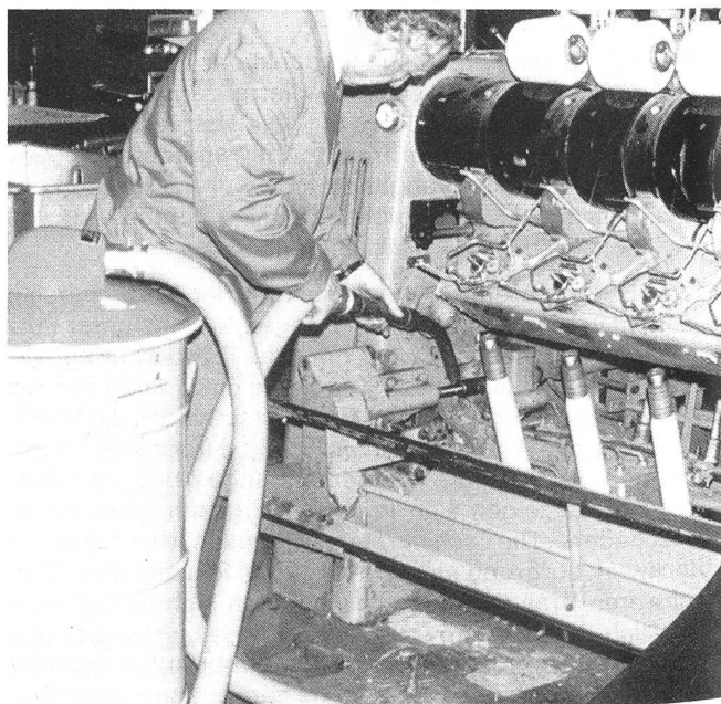
Regelmässige, gründliche Reinigung der Maschinen verhindert Überhitzung und damit Brandursachen. Die Hochleistungssauger gen. Absaugapparate saugen auch klebenden Flug, Schmiere usw. dank dem hohen Vakuum von 8000 mm WS und ermöglichen die Eliminierung von Druckluft zur Reinigung. (Abb. Absaugapparat AP-75 Abb. WILD AG ZUG)
