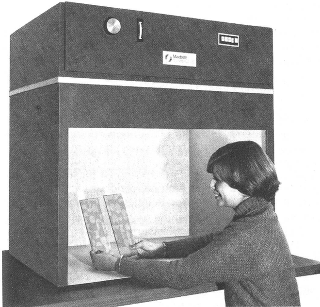
Abb. 8: Farbprüf-Kabinenlampe Macbeth-Spectralight mit Nordhimmel-Tageslicht 2x750 Watt (7500 K), kühlweisses Fluoreszenzlicht (4400 K), Sonnenuntergangslicht = Glühlampenlicht (2300 K) und Ultraviolett-Röhren. Die letzteren sind einzeln oder zu den andern Lichtarten zuschaltbar.
