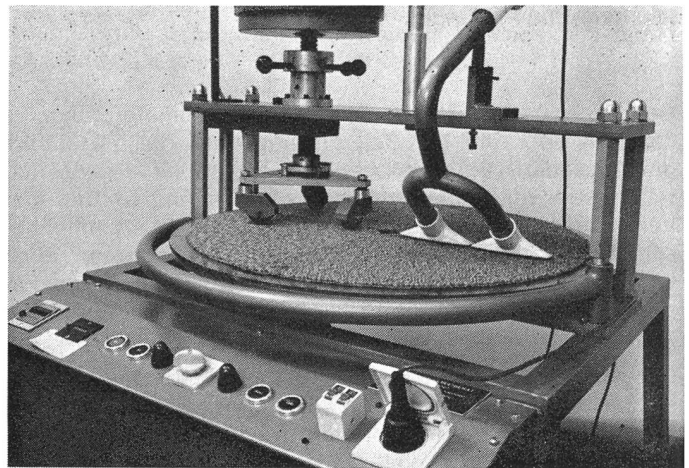
Rollstuhltest. Nach 5000 und 25 000 Umdrehungen des Probenstückes wird der Teppich beurteilt. Die Rollen liegen mit je 300 N auf dem Teppich.
