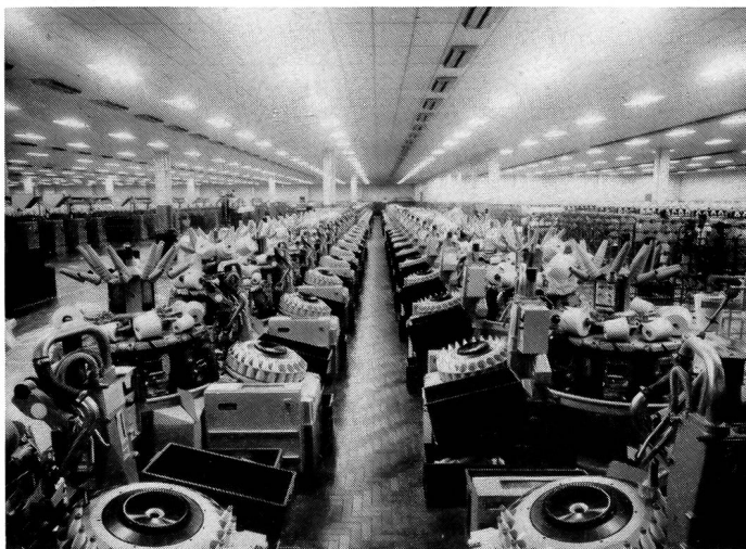
62 Schweiter-Coner CA 11 (620 Spindeln) in einer hochmodernen Rieter-Spinnerei in Nord-Brasilien.
