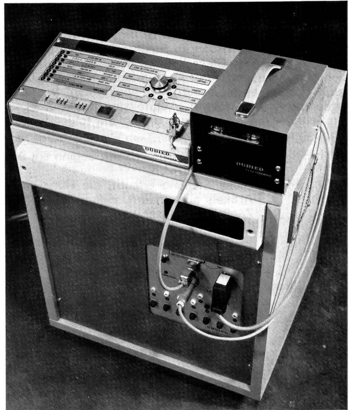
Bild 4 JET 2 (-F). Steuerschrank mit Datenänderungspult und schnell laufendem Aufnahme- und Lesegerät.
