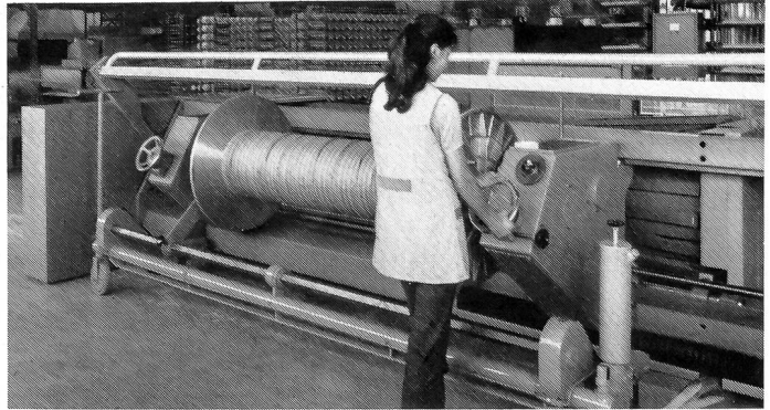
Abb. 2 SC-PERFECTRONIC Bäumseite mit Kettbau-Hubwagen
