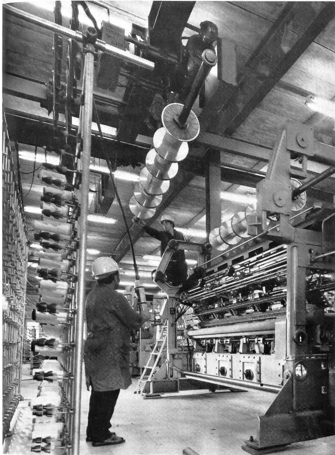
Mann m. Helm Fallblechmaschine mit elektrischer Fadenabstellvorrichtung. Im Moment werden mittels Kran Teilkettrollen aufgelegt.
