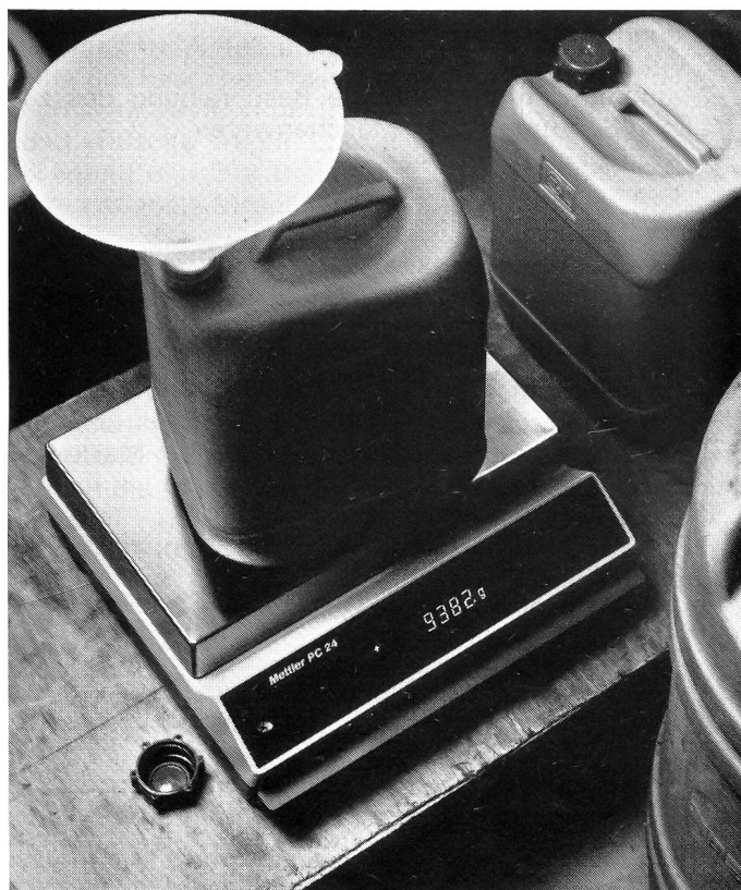
Mettler PC 24 Elektronische Präzisionswaage Wägebereich: 0...24.000 g. Ablesbarkeit: 1 g
