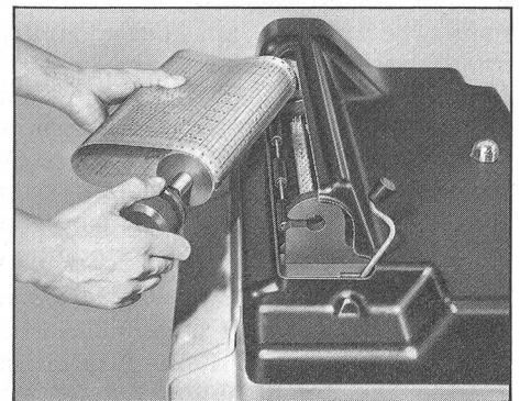
Die kompakte, für hohe Arbeitsgeschwindigkeiten ausgelegte Steuergruppe 5 zeichnet sich durch den kontinuierlichen Vorschub der Musterkarte und den schwenkbaren Kartenzylinder aus.
