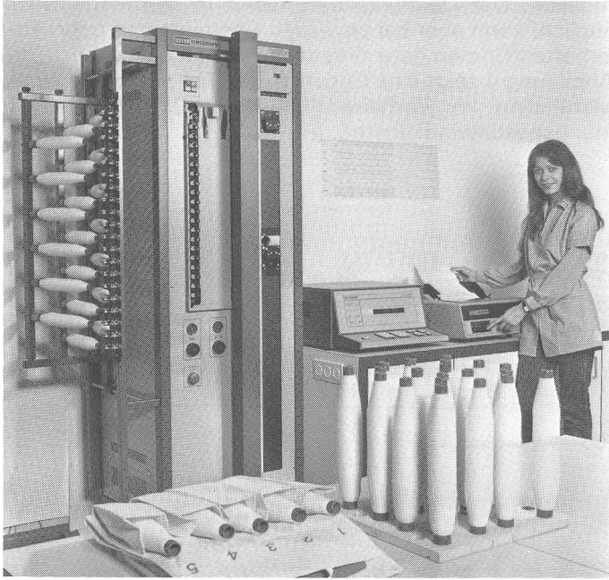
Abb. 6 Uster Tensorapid Festigkeitsprüfanlage für alle Norm- und Schnellprüfungen bis 5000 mm Verformungsgeschwindigkeit.
