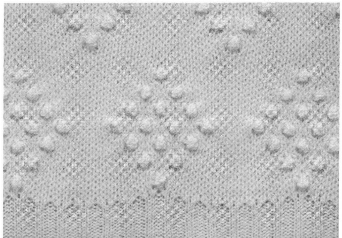
Abb. 6 Halbschlauch-Gestrick mit Noppen in jacquardmässiger, versetzter Anordnung
