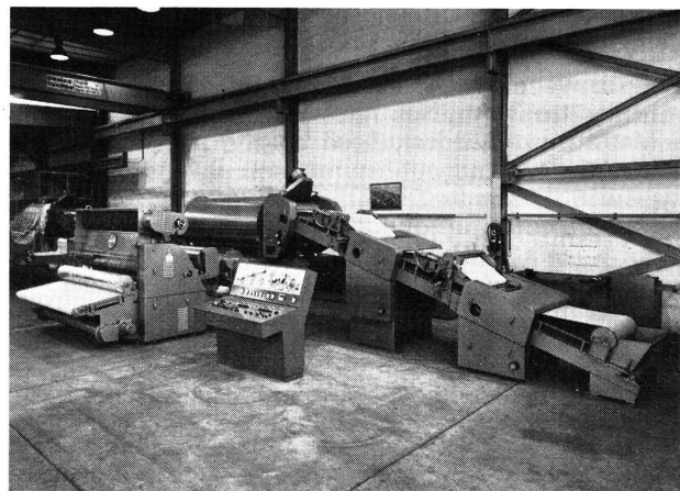
Bild 1 Nonwoven-Anlage, Type V 21/K 12: 2,6 m Arbeitsbreite
