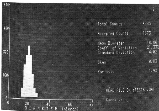
Bild 3: Bildschirmanzeige mit Histogramm und numerischen Daten nach der Messung
