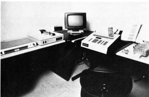
System 18 Stäubli-Programmiersystem für elektronisch gesteuerte Schafmaschinen
