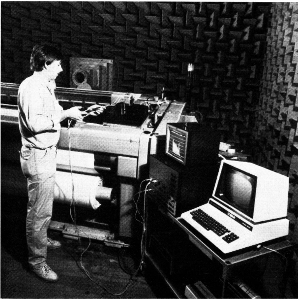
Akustische Intensitätsmessung an einer Sulzer-Webmaschine
