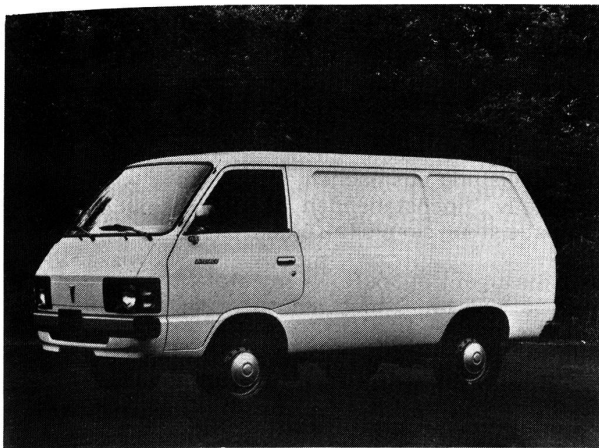
Toyota Lite Ace 1300 4 Türen, 2 bis 9 Plätze, 4 Zylinder, 1290 ccm, 43 kW (58 PS) DIN
