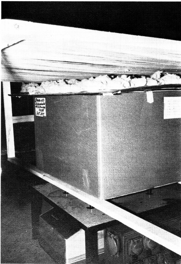
Fig. 1 250 g Flugbaumwolle unter Kettenfäden auf Platte von 115 x 75 cm gleichmässig verteilt
