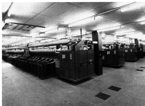
Abb. 2 Rotor-Spinnspul-Automat AUTOCORO mit INFORMATOR
