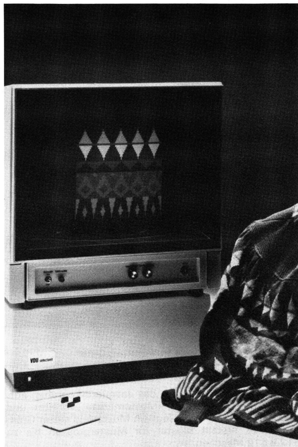
Abb. 3 Farbmonitor mit Mischregler zum Einregeln der Farben
