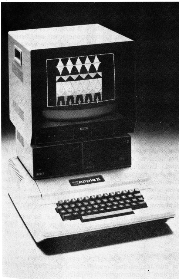
Abb. 2 Rechner mit Diskettenlaufwerk und Schwarzweiss-Monitor
