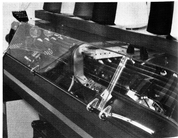
Abb. 10 Der Bewegungsraum des Schlittens ist verkleidet
