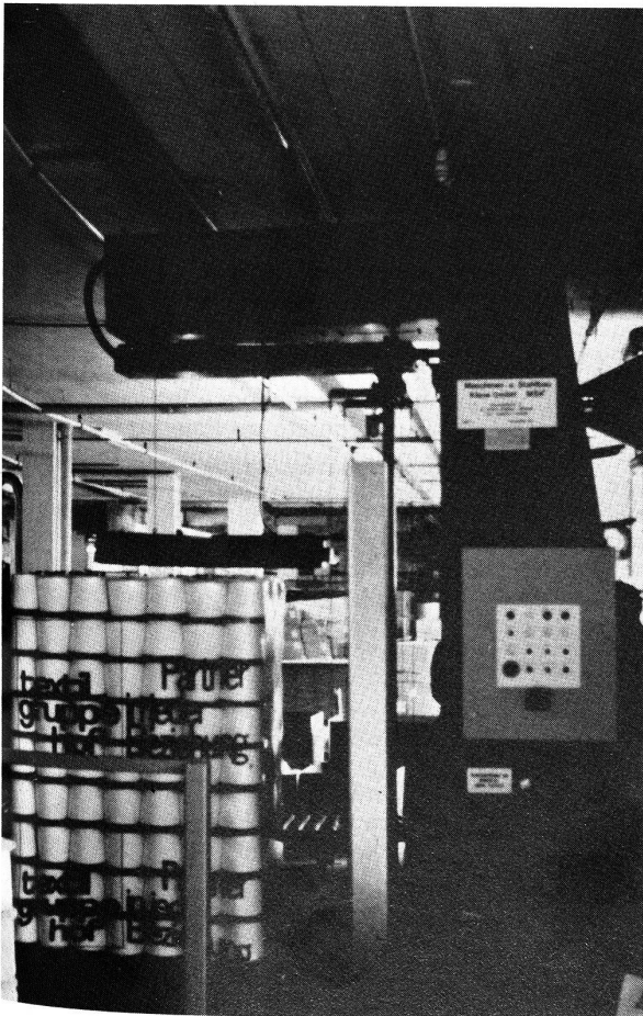
Abb. 1 Die Baumwollknen werden ohne Kartonboxen auf die Palette gestapelt und mit der MSK Schrumpfmachine sauber und kostensparend eingeschrumpt.
