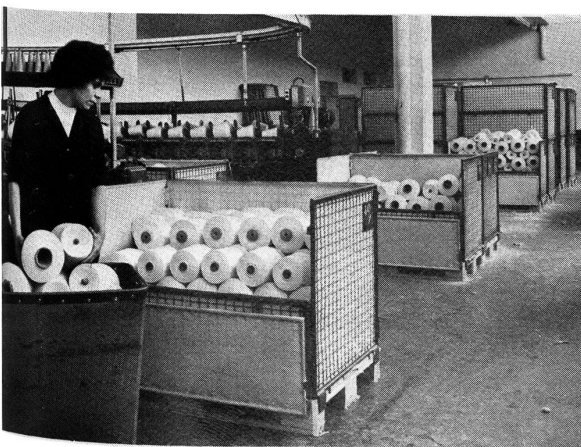
Aufsetzgitter mit Kreuzspulen in einer Spinnerei Werkfoto: Drawag AG
