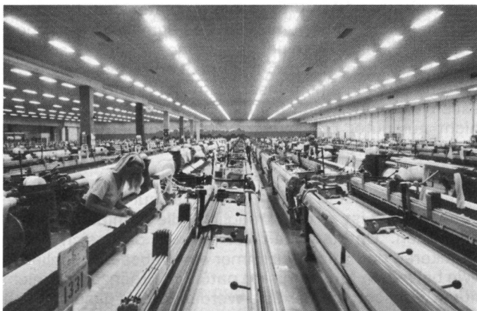
Bild 13 Moderne Webmaschinenanlage mit 192 Sulzer-Rüti-Projektwebmaschinen
