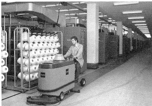
Bild 1 Für grössere, nicht überstellte Flächen stellt der Einsatz von Reinigungsautomaten die wirtschaftlichste Lösung dar.
