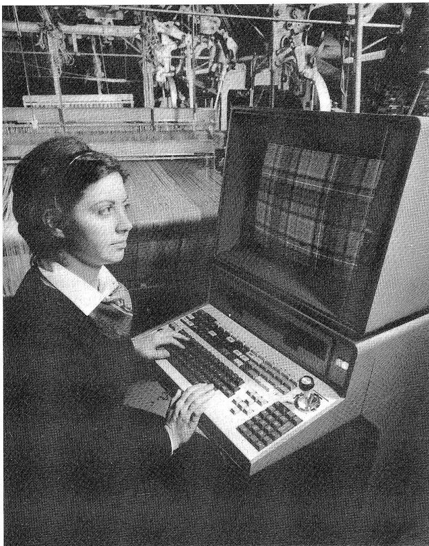
Die Komplexität des auf diesem Computerterminal gezeigten buntkarierten Schottenstoffes ist ein Beispiel für die vielfältige Verwendbarkeit des neuen Webarten-Simulationsprogrammes, das es den Textildesignern ermöglicht genau vorherzusagen, wie ein neues Muster aussehen wird.
