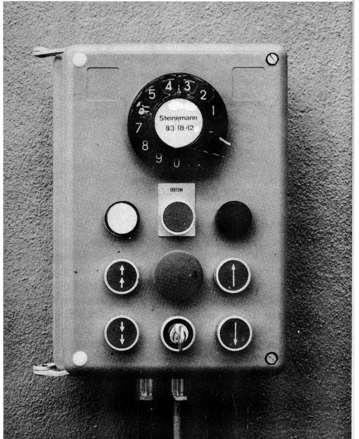
Bild 6: Bedienungsschalter mit Telefonwählscheibe für Wahlautomatik, Irrtumstaste, Stoptaste, je eine Anlauftaste, Langsam- und Schnellgang für Links- und Rechtslauf, Leuchtknöpfe grün und rot, abschliessbar.
