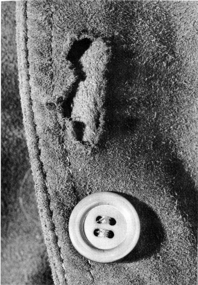
Abb. 4: Lochbildung wegen stellenweise zu geringer mechanischer Festigkeit des Leders bei der Trockenreinigung.
