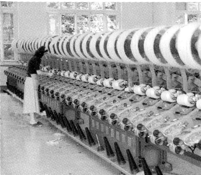
Strangspulen: Zurückspulen der mercerisierten und gefärbten Baumwollzwirne auf Konen
