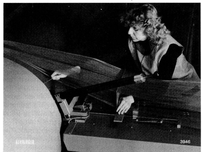
Abb. 7: Ausgeschwenkte Führungswalze mit automatischer Rückstellung des Schärblattes.
