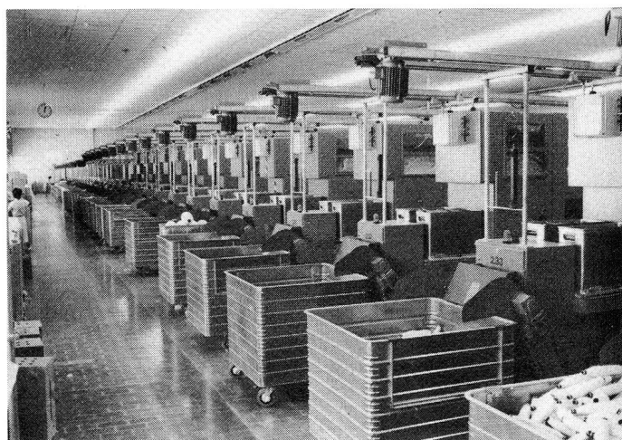
Bild 1 Einer der beiden Ringspinnäle im Neubau mit Zinser-Ringspinnmaschinen und Doffer
